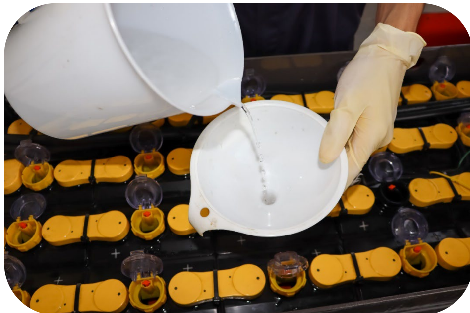
富液式铅酸电池电解质维护 (补充水)
