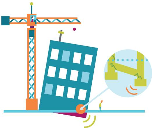
Fallo de los cimientos que cause un asentamiento de la edificación. Dentro de las posibles causas se encuentran errores en estudios geotécnicos o en el diseño de los cimientos.
